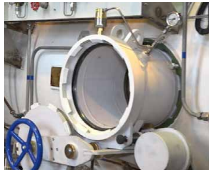
Фото 8. Съемный шлюз барокамеры.
