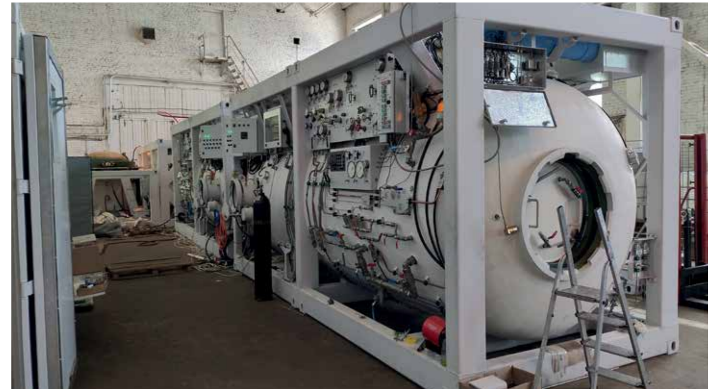
Фото 6. Барокамеры модульной системы МССЭ, соединенные в единый комплекс в цехе.
