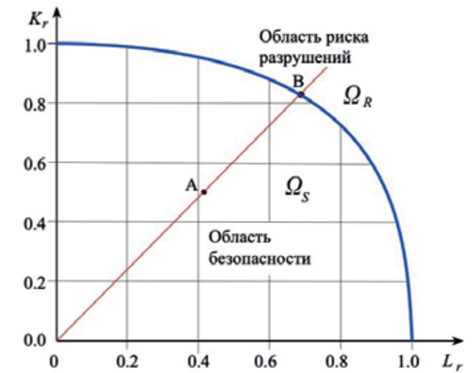
Рисунок 2 – Диаграмма разрушения (а) и диаграмма трещиностойкости (б)
