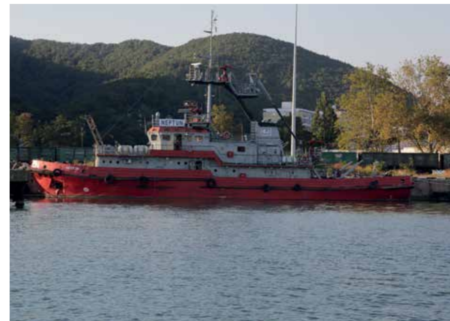
Аварийно-спасательное пожарное судно НЕПТУН, проект-14613, год выпуска - 1996, длина - 39,8, ширина - 7,8, осадка 2,2, водоизмещение - 385 т.
