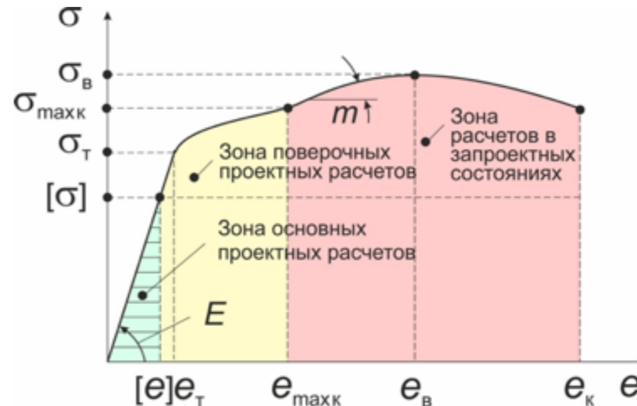
Рисунок 3. Расчетная диаграмма статического деформирования для зон основных и поверочных расчетов прочности
