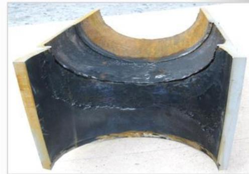
Выявленные коррозионно-эрозионные повреждения линии 102/8 от П-101/2-3 к К-102, секция 100, установка ЛК-6Ус
