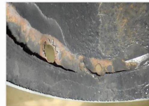
Выявленные коррозионно-эрозионные повреждения трансферной линии из печи П-2 в реактор Р-1 установки 43-102
