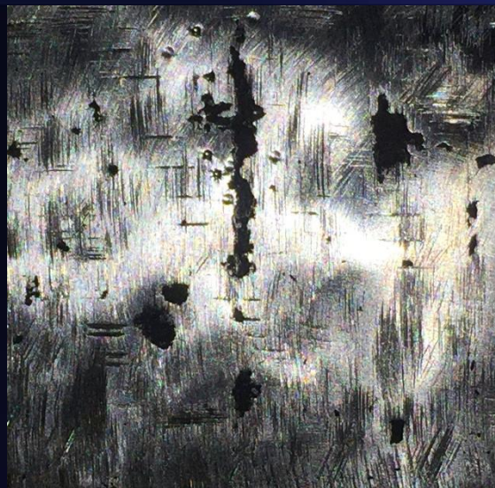
Очаговые каверны вытянутой или округлой формы в ЗКН 8 (5*) и 15 сляба №5.
