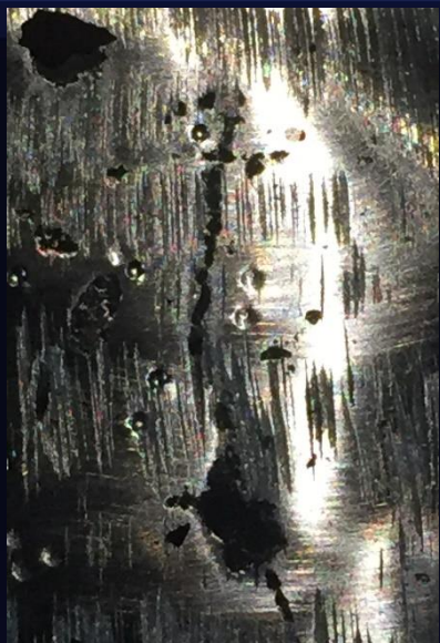
Очаговые каверны вытянутой или округлой формы в ЗКН 8 (5*) и 15 сляба №5.
