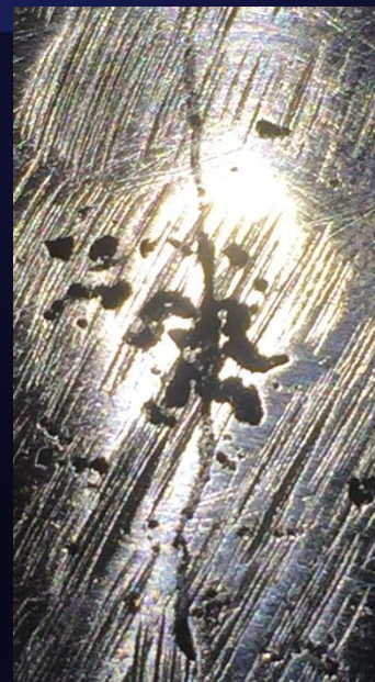
Очаговые каверны вытянутой или округлой формы в ЗКН 14 сляба №8
